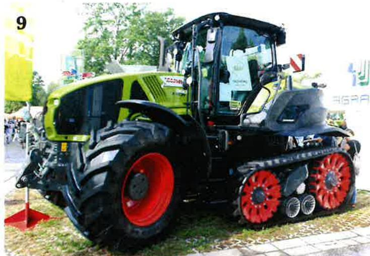
U+M servis, s. r. o., získala ocenění za polopásový traktor CLAAS Axion 960 Terra Trac (9). Polopásový traktor se vyznačuje originální konstrukcí pásového podvozku, který umožňuje po celé délce kontakt s půdou i při nerovném terénu. Traktor je vybaven hydromechanickou převodovkou s větvením výkonu využívající čtyři mechanické rozsahy řazené automaticky.
