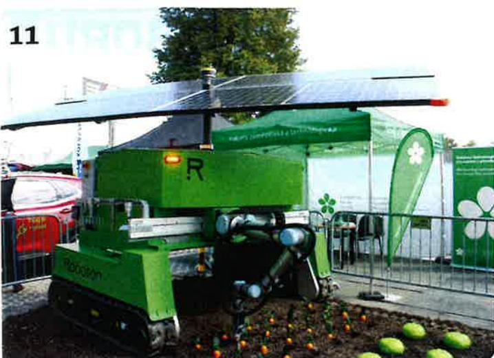
Roboton (11), využívající znalosti z oblasti automatizace, robotiky, vyhodnocování obrázu, navigace a umělé inteligence při pěstování zemědělských lodi. Při svém provozu robot erpá obnovitelnou solární energii.
