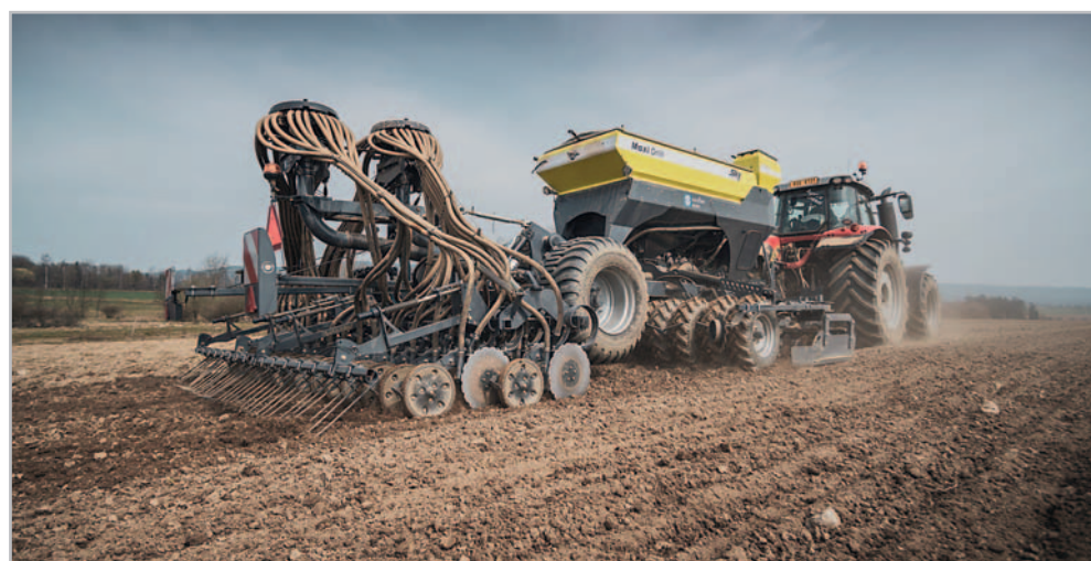
Maxi Drill – secí stroj pro seti do jakkoliv zpracované půdy
