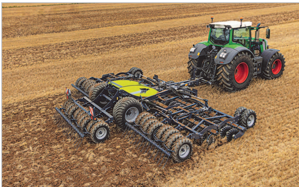
Novinka – Methys – talířový podmítač pro precizní předsetové zpracování půdy
