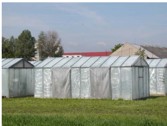
Obr. 2: Izolační klec B – vzduch proudí síťovanými bočními okny a trojúhelníky ve štítu klece
